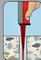
Ispuniti otvor sa kompozitnom masom, počevši od dna
